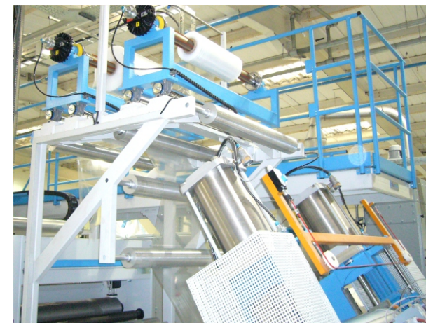
Abrollung direkt über dem Glättwerk mit seitlicher Bühne
